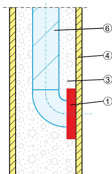
Pose de l'**Easy-Box** à titre d'évidement pour le raccordement de conduites de ventilation.
