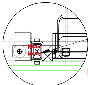
Fixations des profils renforcés sur le montant du châssis Easy-Tech
