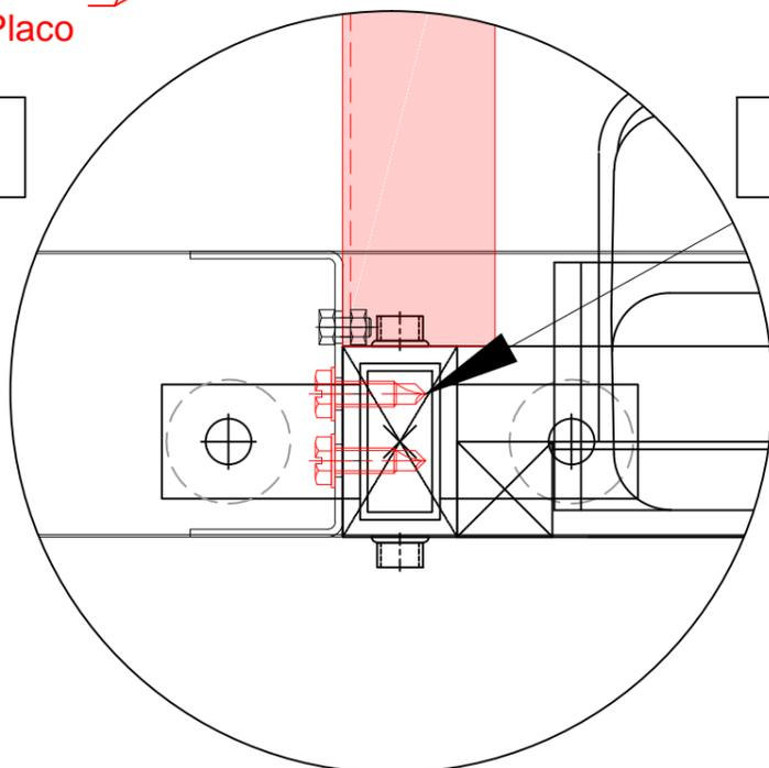
Fixations des profils renforcés sur le montant du châssis Easy-Tech
