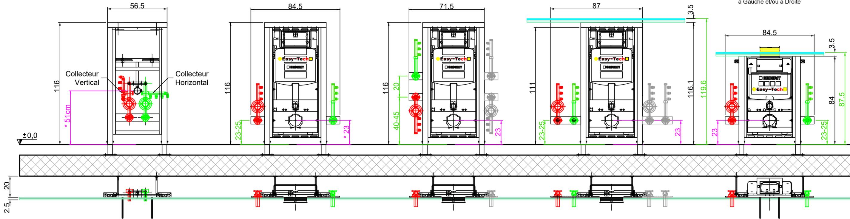
!!! les côtes de 51cm et 23cm (Axe écoulement) peuvent variées selon le Type de l'appareil !!!
